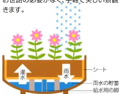
●雨水利用プランターの仕組み(テラポンド工法)
